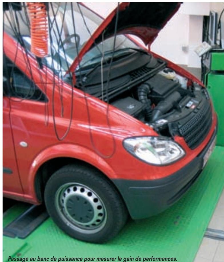
Passage au banc de puissance pour mesurer le gain de performances.
